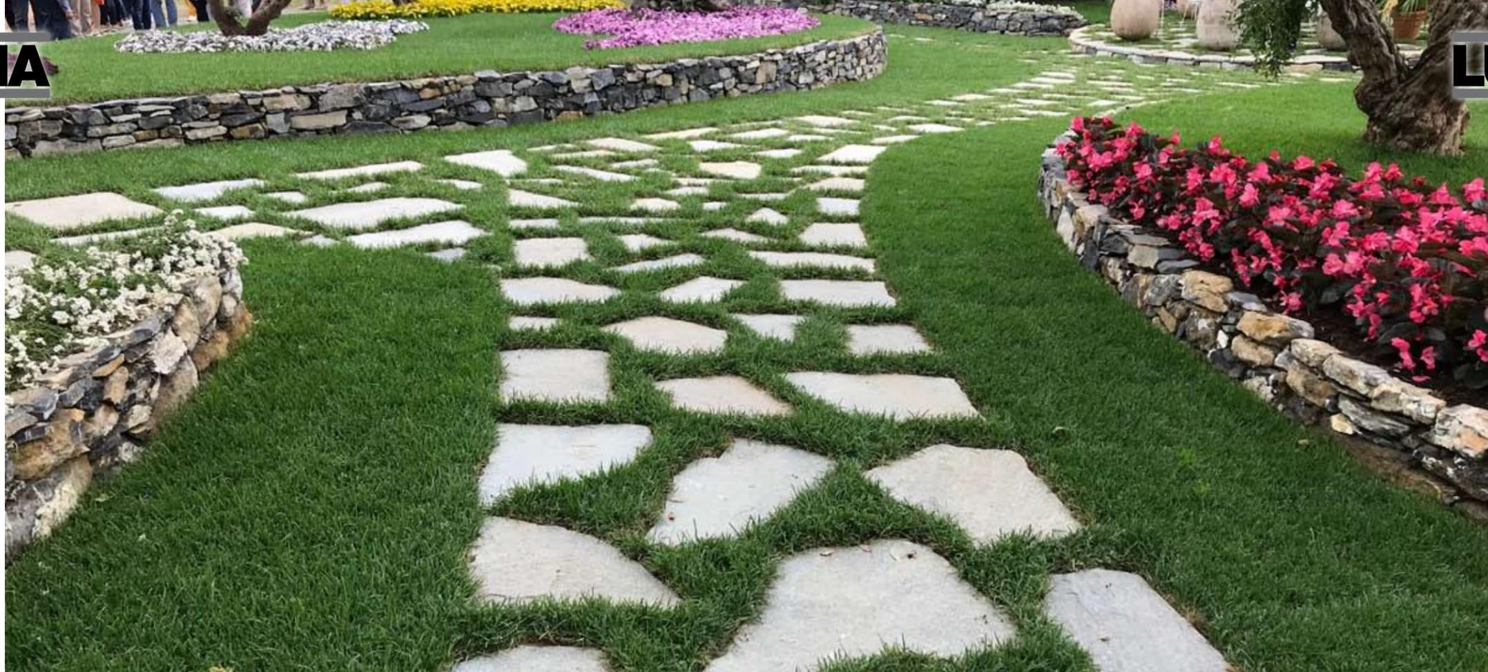
Il Lastrame Gigante unisce al fascino del Lastrame le dimensioni imponenti di questa particolare pezzatura, andando a costituire un elemento architettonico di grande potenza scenica da impiegare sia per le pavimentazioni tradizionali con fughe in cemento che per la posa isolata su prati e superfici non lavorate.
